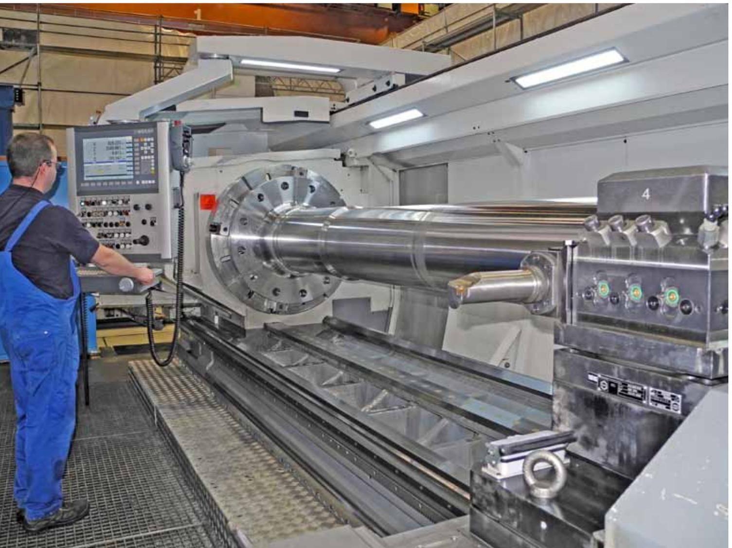
Schottel Schiffsmaschinen fertigt mit der ersten 4-Bahnen-Präzisions-Drehmaschine seine Verstellpropeller:
