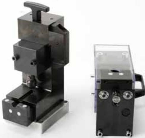
Da das Umrüsten und Neueinstellen bei flexiblen Systemen wie Montagearbeitsplätzen in der Regel mit großem Aufwand verbunden ist, bietet Roemheld optional Dockingstationen zu den Drehmodulen. Kleinere Vorrichtungen zum Spannen oder Fügen können dadurch schnell mechanisch, elektrisch und hydraulisch gekuppelt und eingerichtet werden.
