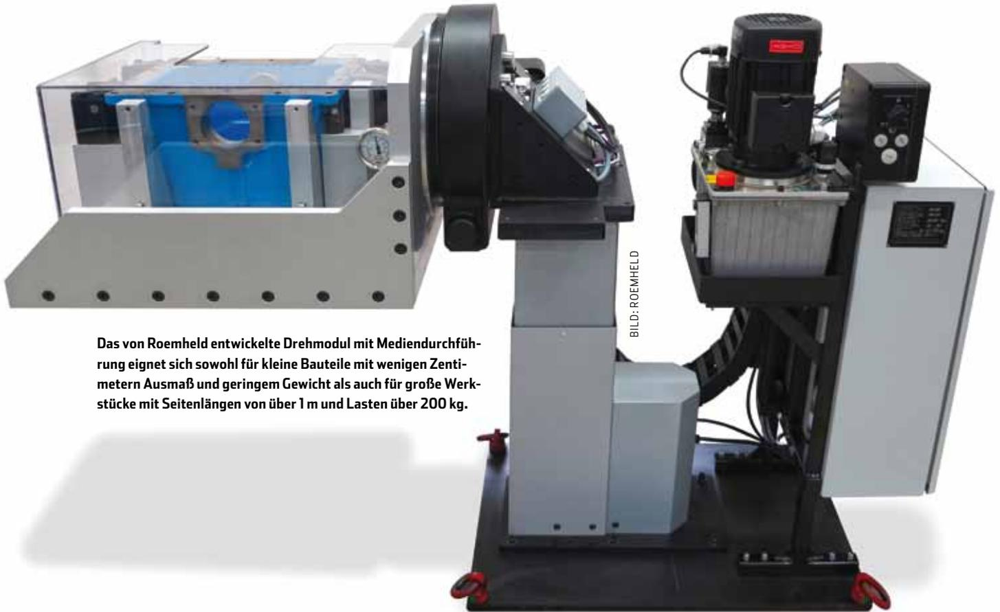
Das von Roemheld entwickelte Drehmodul mit Mediendurchführung eignet sich sowohl für kleine Bauteile mit wenigen Zentimetern Ausmaß und geringem Gewicht als auch für große Werkstücke mit Seitenlängen von über 1 m und Lasten über 200 kg.
