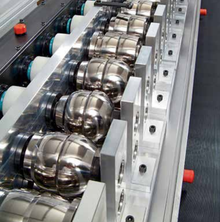
Bild 2: Das Federstahlband wird in einer Profilmetal-Profilieranlage über verschiedene Stationen bis zur fertigen Geometrie umgeformt.
